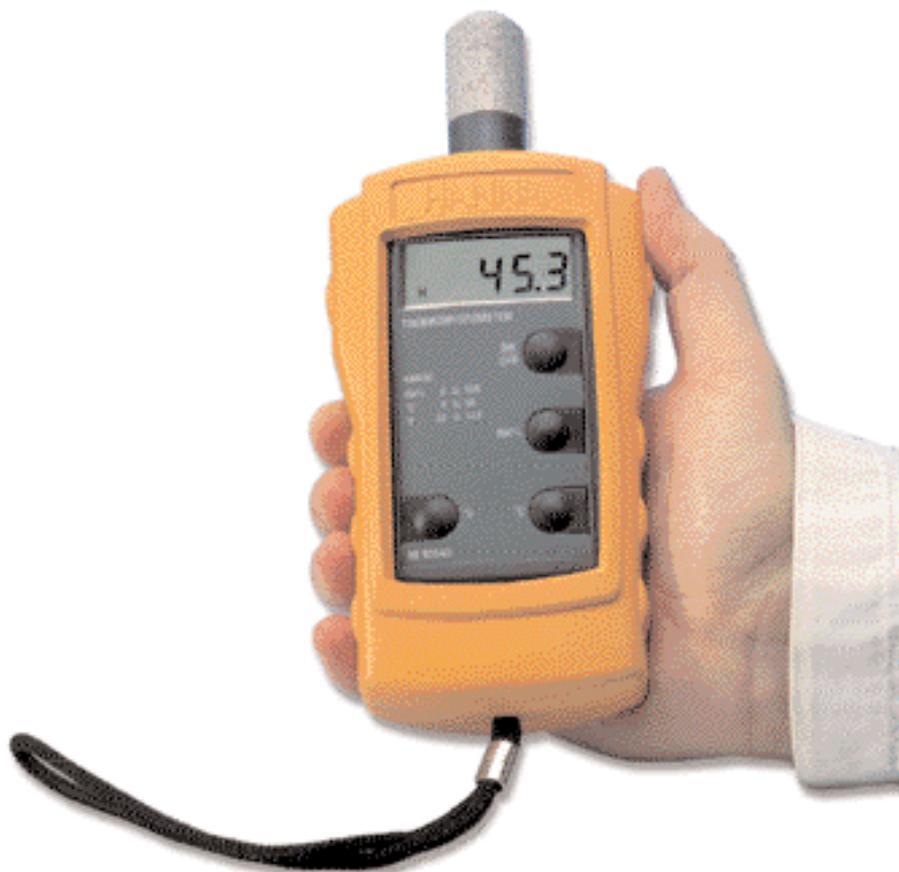
Le modèle HI 93640 est un hygromètre polyvalent compact et portable permettant de contrôler l'humidité relative n'importe où. Le capteur à condensateur à film mince intégré assure des mesures d'humidité précises entre 5 % et 95 % HR, avec une résolution de 0,1 %. La plaque frontale en caoutchouc protège le clavier contre la poussière et les éclaboussures accidentelles.
